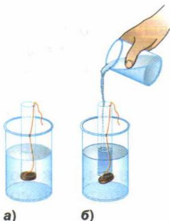
Рис. 109. Отпадание дна сосуда под действием силы тяжести
