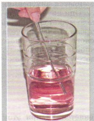
Нагревание стеклянной палочки в горячей воде, свидетельствующее о плохой теплопроводности стекла
