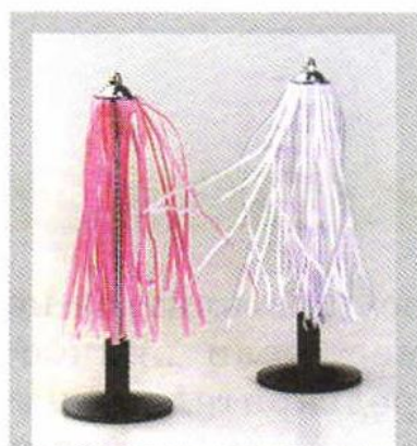
Притяжение разно- имённо заряженных султанчиков
