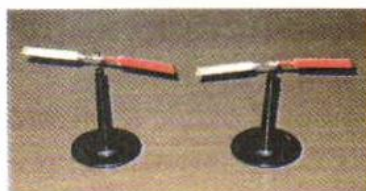
Рис. 111. Взаимодействие магнитных стрелок
