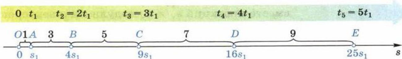
$OA$ ,  $OB$ ,  $OC$ ,  $OD$  и  $OE$  представляют собой модули векторов перемещений ( $s_1$ ,  $s_2$ ,  $s_3$ ,  $s_4$  и  $s_5$ ), совершенных телом соответственно за промежутки времени  $t_1$ ,  $t_2 = 2t_1$ ,  $t_3 = 3t_1$ ,  $t_4 = 4t_1$  и  $t_5 = 5t_1$ .
