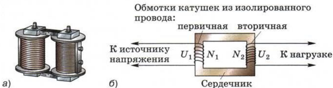
Рис. 134. Внешний вид и схема устройства повышающего трансформатора
